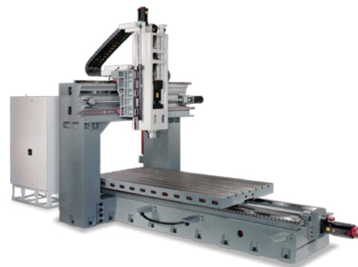
Frezarka STYLE DC-LL Frezarka typoszeregu LL jest wyposażona w prowadnicę liniową osi X, Y i Z.
